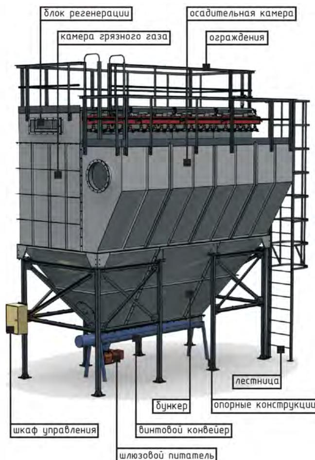
который подаётся через продувочные трубы. При стряхивании пыль осыпается в бункер фильтра, откуда через отверстие выгрузки выводится из фильтра.
